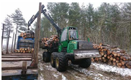
2. ábra: John Deere harvester és John Deere 1910E forwarder folyamatgépesített fakitermelés (DALERD Zrt., Ásotthalmi Erdészet, erdei- és feketefenyő véghasználat)
