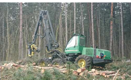
2. ábra: John Deere harvester és John Deere 1910E forwarder folyamatgépesített fakitermelés (DALERD Zrt., Ásotthalmi Erdészet, erdei- és feketefenyő véghasználat)
