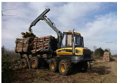
1. ábra: Ponssé Beaver harvester és Ponssé Wisent forwarder folyamatgépesített fakitermelés (DALERD Zrt., Ásotthalmi Erdészet, feketefenyő véghasználat)
