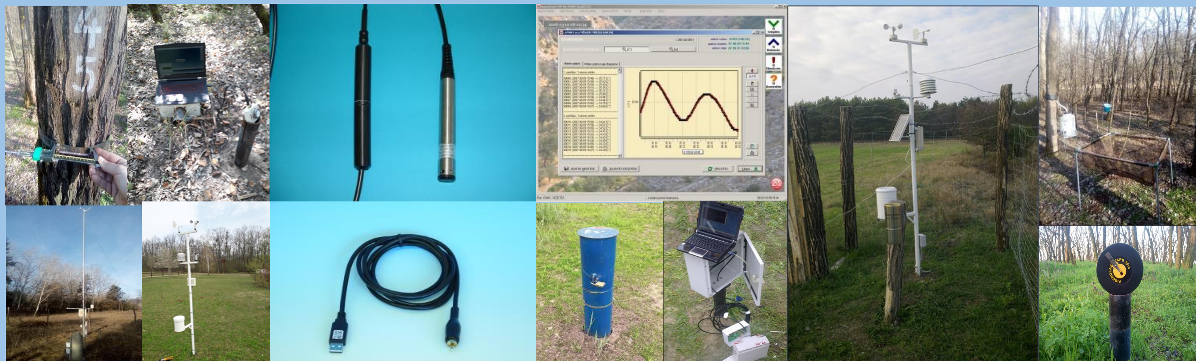
3. ábra: Az alföldi monitoring hálózatban lévő automata (talajvízszint érzékelő, meteorológiai állomás) és manuális eszközök (biomassza mérő, növekedésmérő-szalag).
