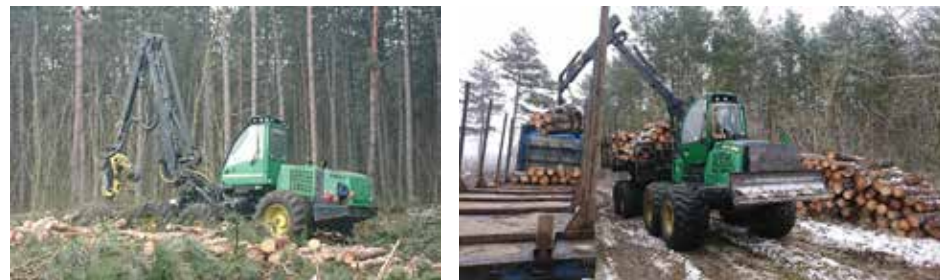
3. ábra: John Deere harvester és John Deere 1910E forvarder (Forrás: saját kép)
