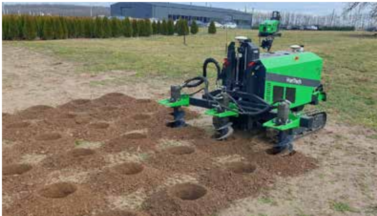
2. ábra. A 3 fúrófejjel szerelt haRiBOT V3 önjáró robot
