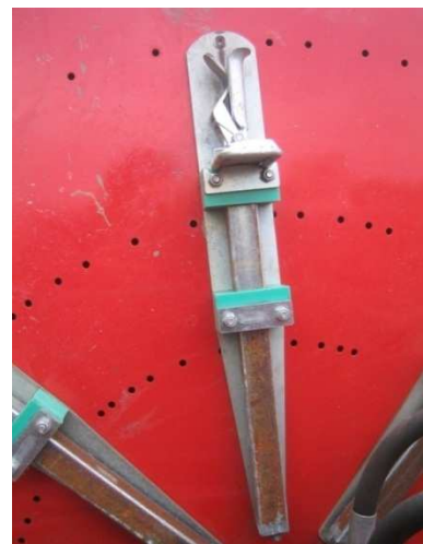
9. ábra: Lökőrendszerű adagolószerkezet fogóleme
