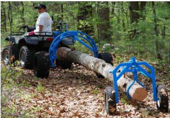
3. ábra, Emelve közelítés rönkfóó ollós közelítő kerékpárokkal
