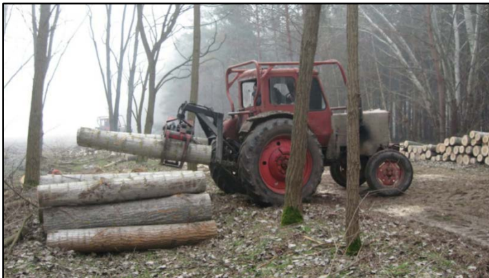
2. kép: Rakodói anyagmozgatás MTZ-52 típusú markolós vonszolóval (Forrás: Szabó, 2019)
